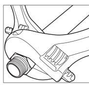
TIGHTEN TIGHTEN THE AUTOSNAP FITTING TO THE SPECIFIED TORQUE VALUE
